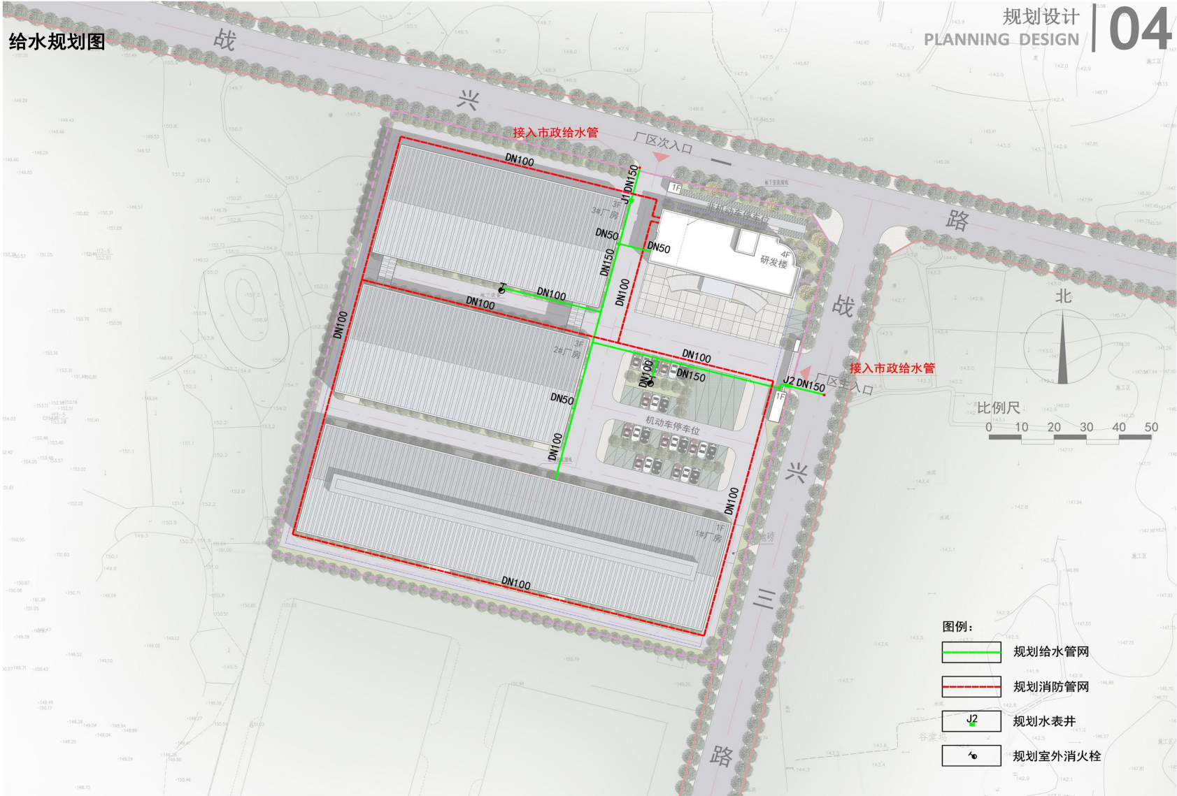
附图 3 厂区给水管网图:
